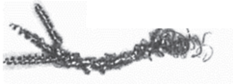
Virutas con PO-VA a 4 m/min
