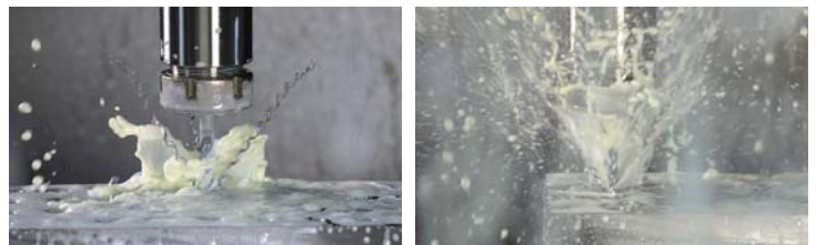
Evacuazione con pressione a 1.5 MPa (15 Bar)
